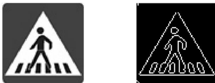
Fig3. Sobel edge detection.
